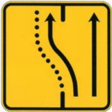
TS-61 Desvío de un carril por la calzada opuesta, manteniendo otro por la de obras
