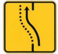
TS-60 Desvío de un carril por la calzada opuesta
